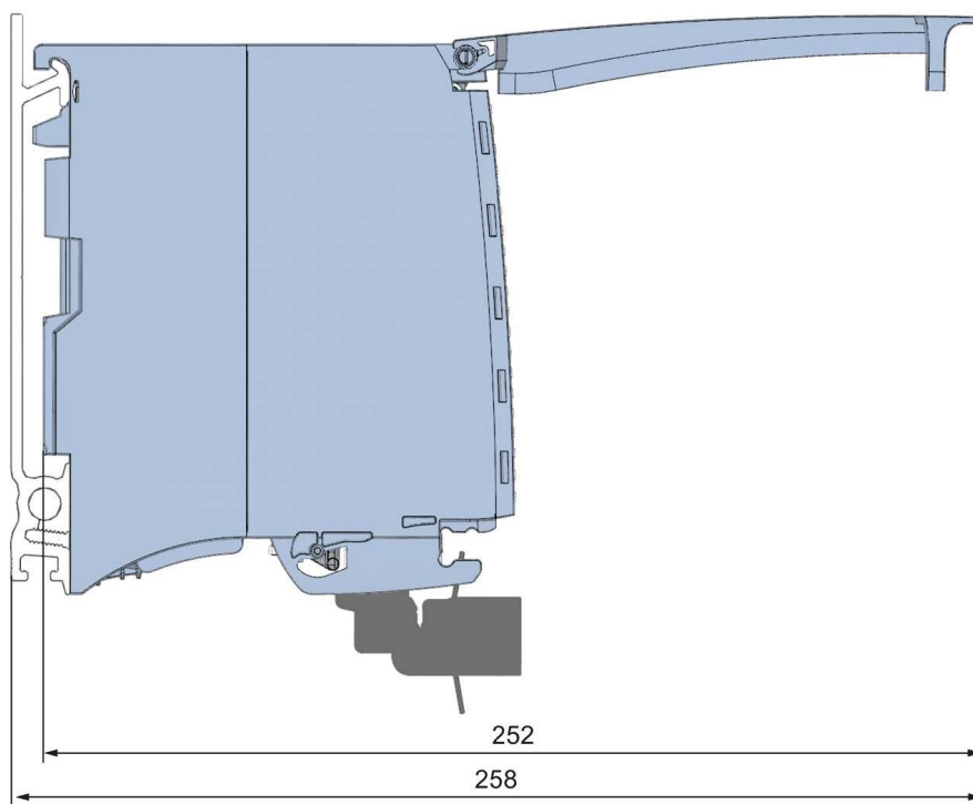
Рисунок А-2 Габаритный чертеж модуля AI 8xU/I HF (вид сбоку, открытой передней крышкой)
